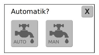
Bei betätigen der Taste "AutoFill" kann automatisch bis zur Füllhöhe 1 befüllt werden. Ein weiterer Tastendruck beendet die automatische Füllung. Das automatische Befüllen wird beendet wenn die entsprechende Füllhöhe erreicht wurde:
