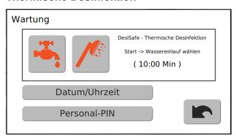
Die Steuerung verfügt über eine thermische Desinfektion, um das Durchspülen der Armaturen mit heißem Wasser über 43°C zu er möglichen.
