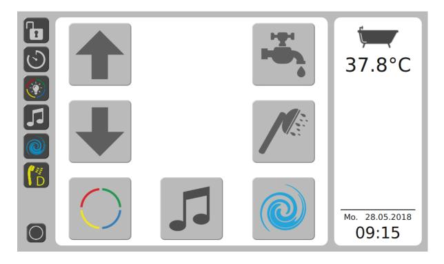
Das Touch-Bedienteil dient dazu, sämtliche Funktionen der Badewanne bequem zu bedienen. Auf dem Display wird die aktuelle Konfiguration und Bedienmöglichkeiten der Wanne angezeigt. Hierzu zählen z.B. das Whirlsystem mit Gebläse oder Pumpe, LED-Farblichtscheinwerfer(n), automatische Wannenfüllung (1 Füllhöhe) und Handbrause, die Hubvorrichtung, Soundsystem (Bluetooth / USB), Desinfektionsanlage, Timer, Tastensperre, Logbuchfunktionen, Thermische Desinfektion und Datum und Uhrzeit.
